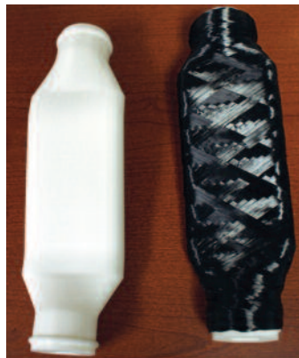
Kerne aus AM-Stützmaterial, abwaschbar
