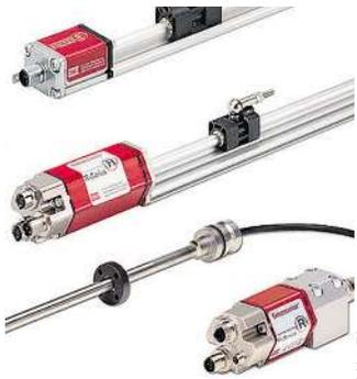
Die kompakten Bauformen Stab (EH), Profil (EP) und ultraflaches Profil (EL) der Temposonics-E-Serie sind mit digitalen SSI- und CAN-Open-Ausgängen erhältlich. Die Positionssensoren der Temposonics-R-Serie können nun auch mit Profinet-Ausgang ausgerüstet werden. Der Sensor ist direkt in der Steuerung sichtbar und der Messwertgeber liefert neben der Position auch Geschwindigkeitswerte. Der Temposonics-RF hat einen flexiblen Sensorstab und bietet eine Messlänge bis 20 m. (ff)
