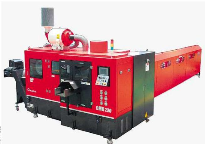
Das Schräglademagazin und eine automatische Anschnitt- und Reststücksortierung gewährleisten einen vollautomatischen Produktionsablauf.
