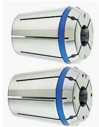
schon mehr und mehr abgedichtete Spannzangen eingesetzt. Diese ersetzen die Ausführung mit Sondermutter und Dichtscheiben, verringern somit die Komplexität des Systems und erlauben einen höheren Kühlmitteldruck bis 120 bar.
