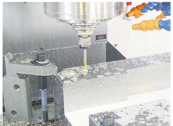
Mit bis zu 1200 N/mm<sup>2</sup> und zwei ungleich gedrahten Spiralwinkeln ist der CC-NEO ein Allrounder.
