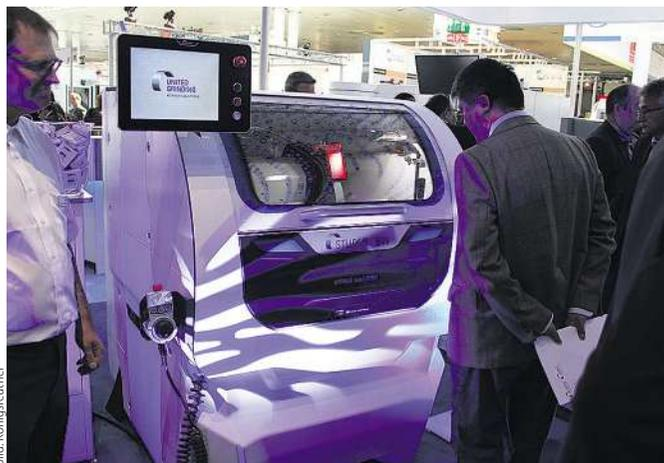
Körper Schleifring heißt jetzt United Grinding und enthüllt zu diesem Anlass eine besonders kompakte Rundschleifmaschine namens Studer S11 für das Kleinstteile-Rundschleifen.
