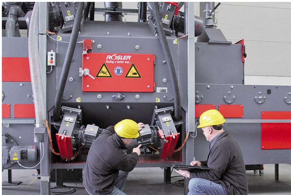
Die Modernisierung beziehungsweise Optimierung stellt häufig eine kostengünstige Alternative zur Investition in eine neue Strahlanlage dar – unabhängig davon, ob es um den Austausch der Strahlturbinen, einen verbesserten Verschleißschutz oder eine zusätzliche Peripherieausrüstung geht.
