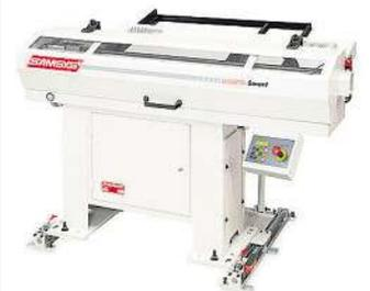
auch im Smart zum Einsatz. Das automatische Lademagazin ist sowohl für Rund- als auch für Profilstangen mit einer Länge bis 1200 mm und einem Stangendurchmesser bis zu 65 mm geeignet.
