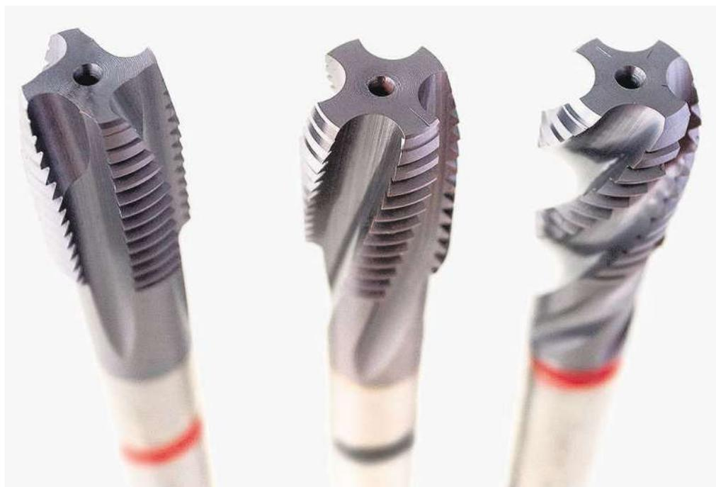
Bei diesen Gewindebohrern hat Hepyc drei Aspekte kombiniert: ASP – pulvermetallurgischen Stahl, eine TiCN-Beschichtung (Titancarbonitrid), die Widerstandsfähigkeit und lange Standzeit gewährt, sowie eine spezielle Geometrie für präzises, leichtgängiges Schneiden.
