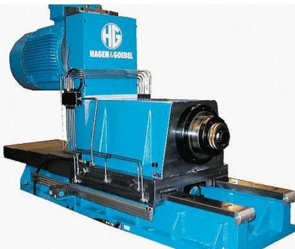
Hagen & Goebel bietet nun Spindeleinheiten mit einer Antriebsleistung bis 50 kW an – der Spannbereich der hydraulischen Zentrierspannstöcke wurde auf 660 mm Durchmesser erhöht. (hk)
