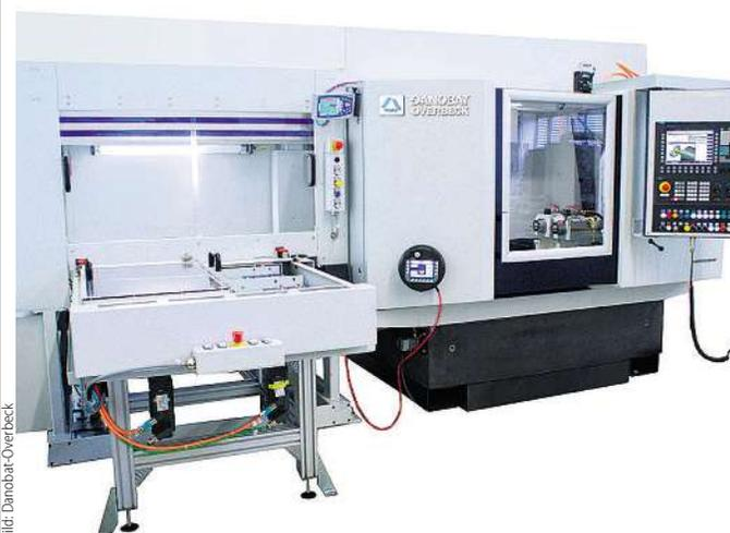
Eine IRD-400 von Danobat-Overbeck mit Palettensystem für das produktive Innen- und Radiusschleifen.
