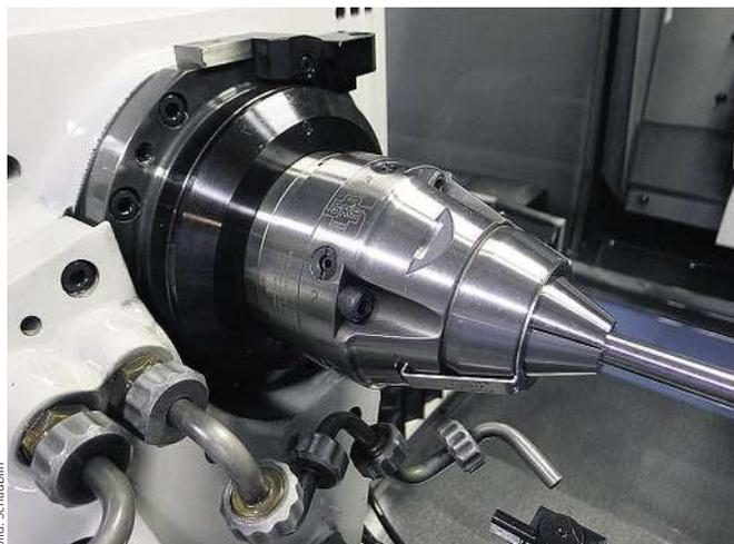
Das Rundlaufausgleichssystem soll zu noch mehr Präzision beim Drehen und Schleifen verhelfen.
