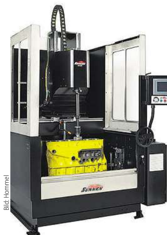
Die vertikale Kreuzschleifmaschine SV20 erreicht ein hohes Abtragsvolumen bei Großteilen, wie etwa Motorblöcken.
