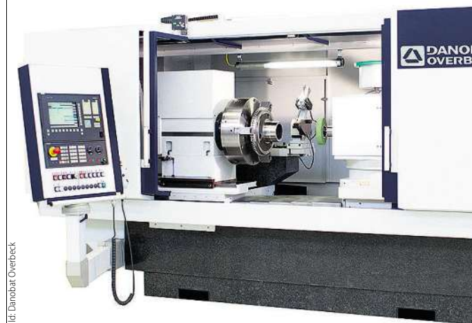
Das Herzstück der ID 600 bildet der Vierfach-Spindelrevolver, der auch über einen Direktantrieb verfügt und mit einer Auflösung von 0,0001° für eine besonders hohe Präzision sorgen soll.
