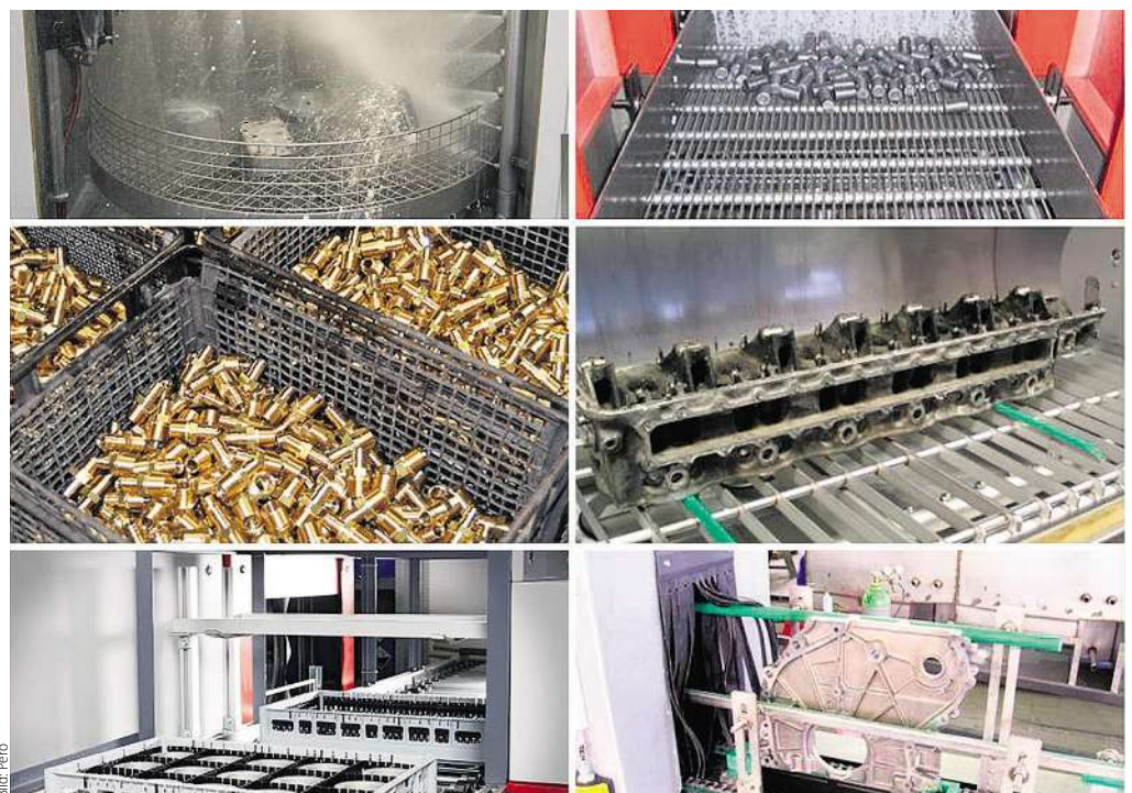
Teilereinigung durch Spritzen, Vollbad und Ultraschall – Pero bietet für jede Anforderung das richtige Verfahren.
