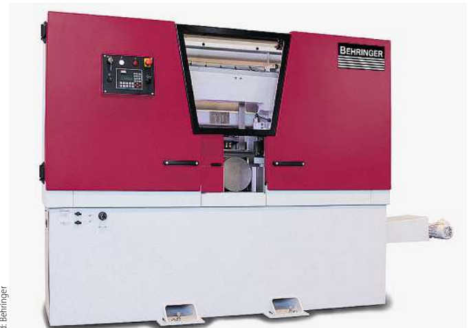
Das kleinste von vier Modellen der HBE-Dynamic-Baureihe, hält über 400 Sägeschnitten bei einem 200 mm durchmessenden Profil aus 42CrMo4 stand.
