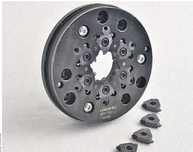
Leitritz zeigt ein Wendepplatten-Werkzeugkonzept für das präzise Wirbeln an kleinen Durchmessern.
