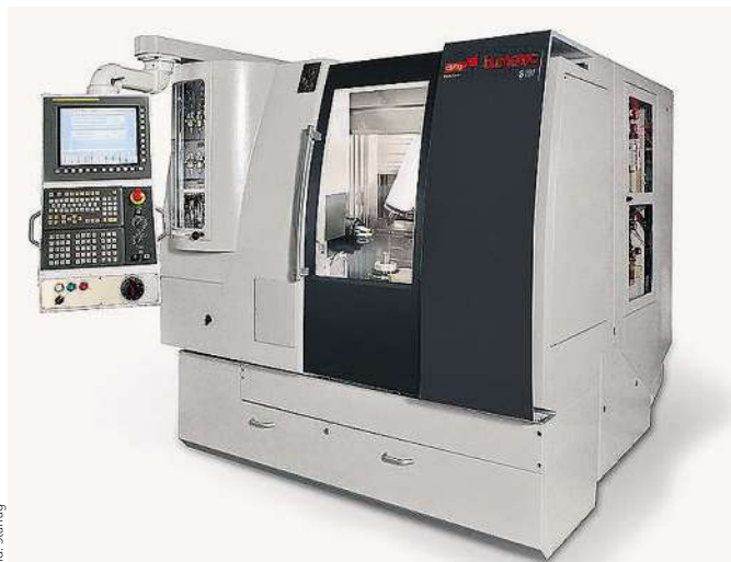
Linearmotoren sorgen bei diesem Transferzentrum für hohe Präzision und Wiederholgenauigkeit.
