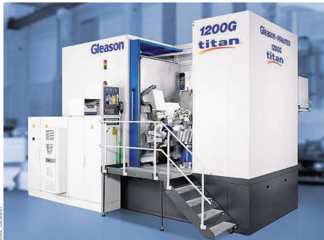
Die Aufstellfläche wurde um etwa 35 % im Vergleich zu sonst üblichen Maschinen reduziert.
