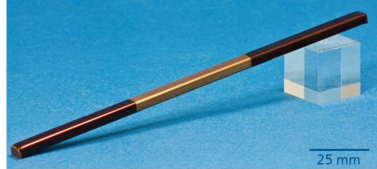
Entfernen der Isolationschicht von Kupfer-Pins
