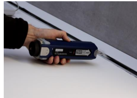
Strömungsanalysen mit Rauch
