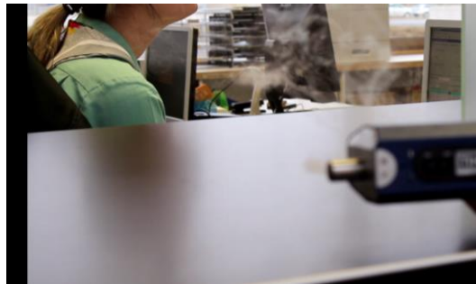
Strömungsanalysen mit Rauch
