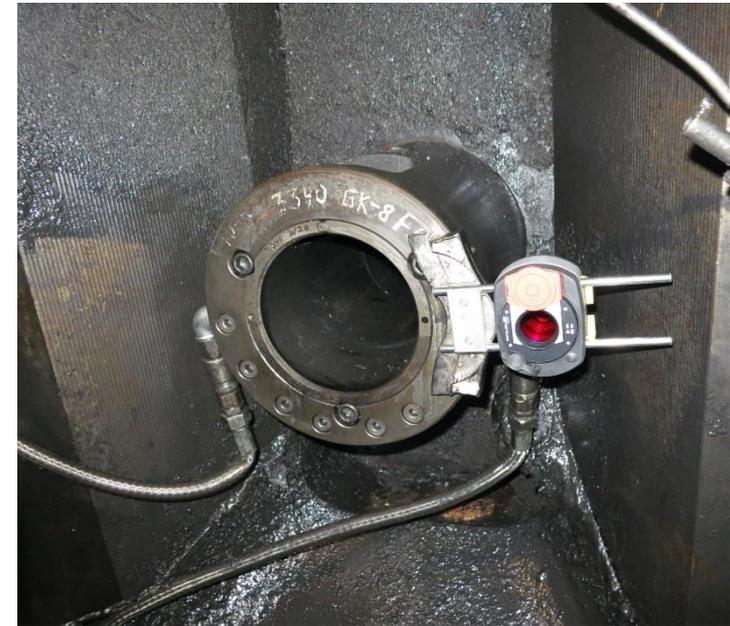
Der hohe Druck wird aufgebaut durch den Schußzylinder, der in einem Bruchteil einer Sekunde mit hoher Geschwindigkeit in die Schußkammer gepreßt wird. Hierdurch wird die flüssige Aluminiumlegierung schlagartig in die Form gepreßt und es entsteht das gewünschte Druckgussteil.
