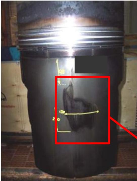
Reibspuren in einem Kolben
