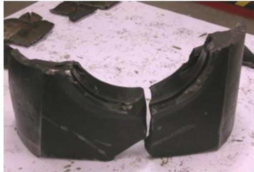
Fragmente eines Kolbens aus dem betroffenen Motor
