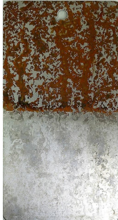
Rost-Entfernung 3 min, 10%, 45°C
