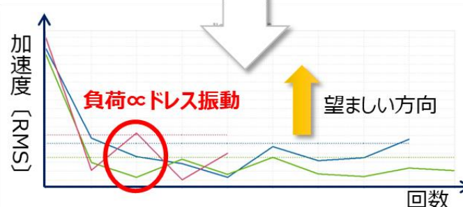
図4. ドレッサ振動をエネルギー量に変換
