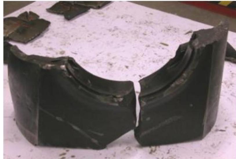
Fragmente eines Kolbens aus dem betroffenen Motor
