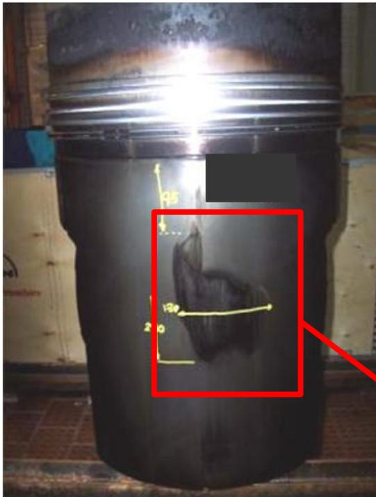
Reibspuren in einem Kolben
