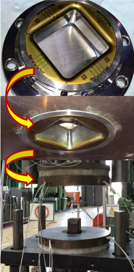
Ziel: Reduzierung von Riss- und Faltenbildung im tiefgezogenen Werkstück
