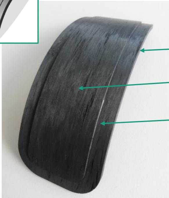
Kachel aus SiC/SiC (unidirektionale Endlosfaser)
