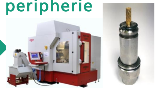
5-Achs-Koordinatenschleif- maschine und Aufspannsystem
