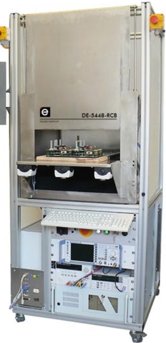
Automatisches Testsystem zur Prüfung von elektrischen und funkrelevanten Parametern
