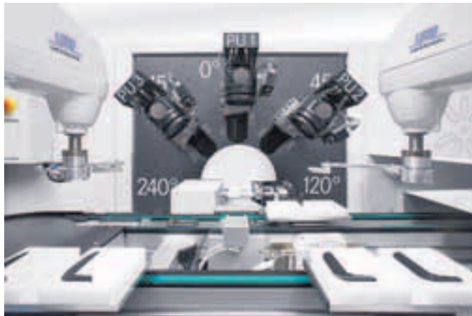
Der neue Laserstrukturierer LPKF Fusion3D bearbeitet die Bauteile mit bis zu vier Lasern aus sieben möglichen Positionen.
