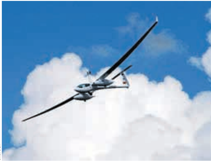
Antares DLR H2, der Motorsegler mit Brennstoffzellenantrieb.
