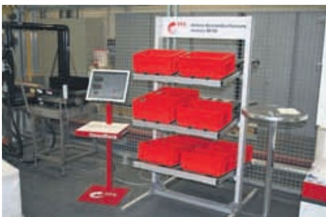
Das Smartrack ist ein branchenneutrales Durchlaufregalsystem zum automatischen Erfassen des Bestands und dessen Management mittels RFID.
