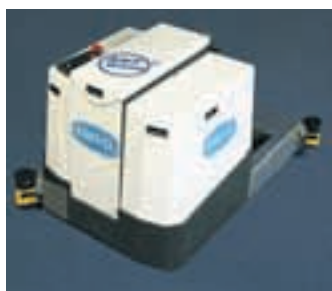
Bei dem Kokeisl Picking Robot handelt es sich um eine ein fahrerloses Transportsystem mit Navigation.
