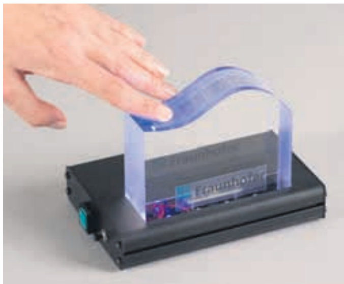
Besucher der Hannover-Messe können es selbst ausprobieren: Eine Annäherung an den flexiblen Tastsensor bringt die Lampe zum Leuchten.
