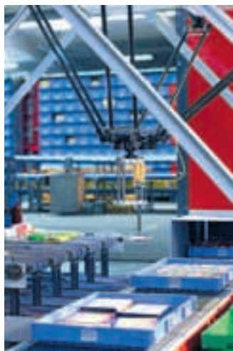
Das Kommissioniersystem Robo-Pick mit zweistufiger Bildverarbeitung leistet 2400 Picks pro Stunde.
