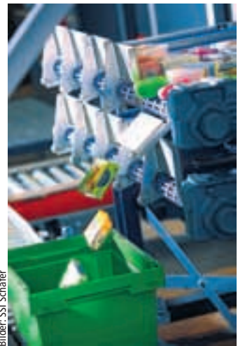
In weniger als einer Sekunde identifiziert die Bildverarbeitungszelle die Position der zu kommissionierenden Waren in einem vorbeifahrenden Tablar und steuert den Pickroboter. Die Artikel werden schonend in den entsprechenden Behälter kommissioniert.
