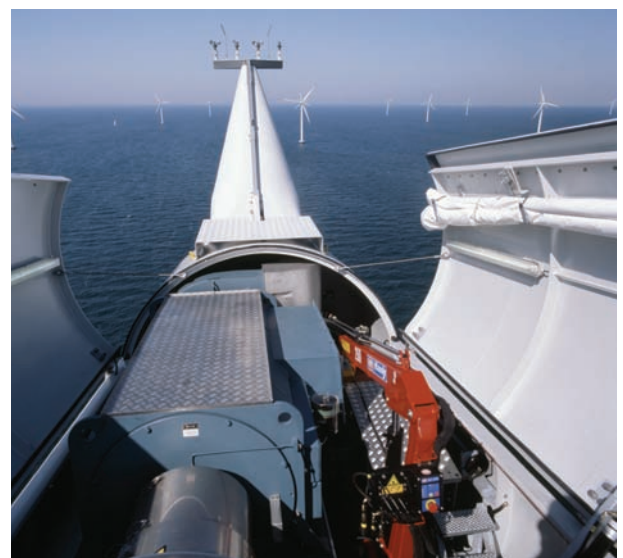
Antriebsstrang einer Offshore-Windkraftanlage.
