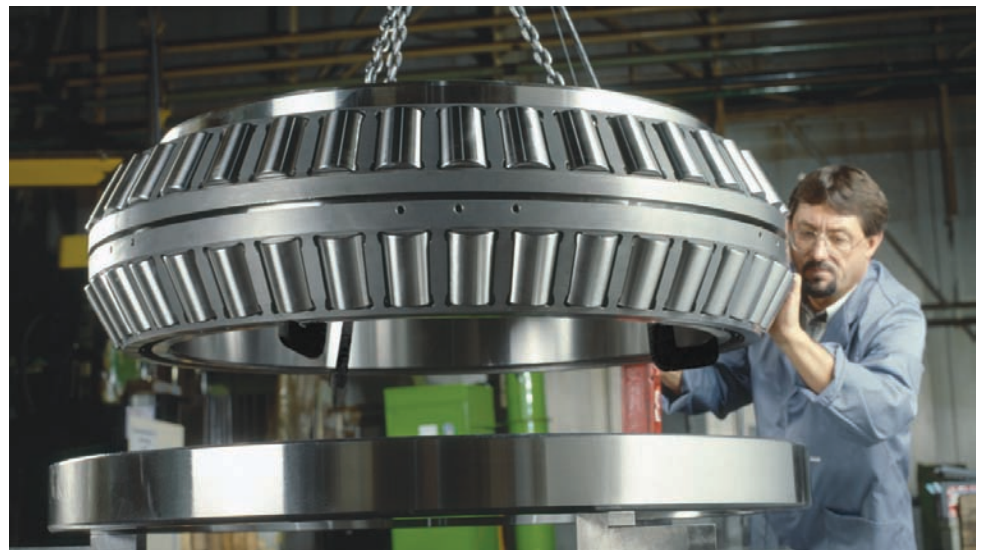
Montage eines Kegelrollenlagers für die Rotorlagerung einer Windkraftanlage.
