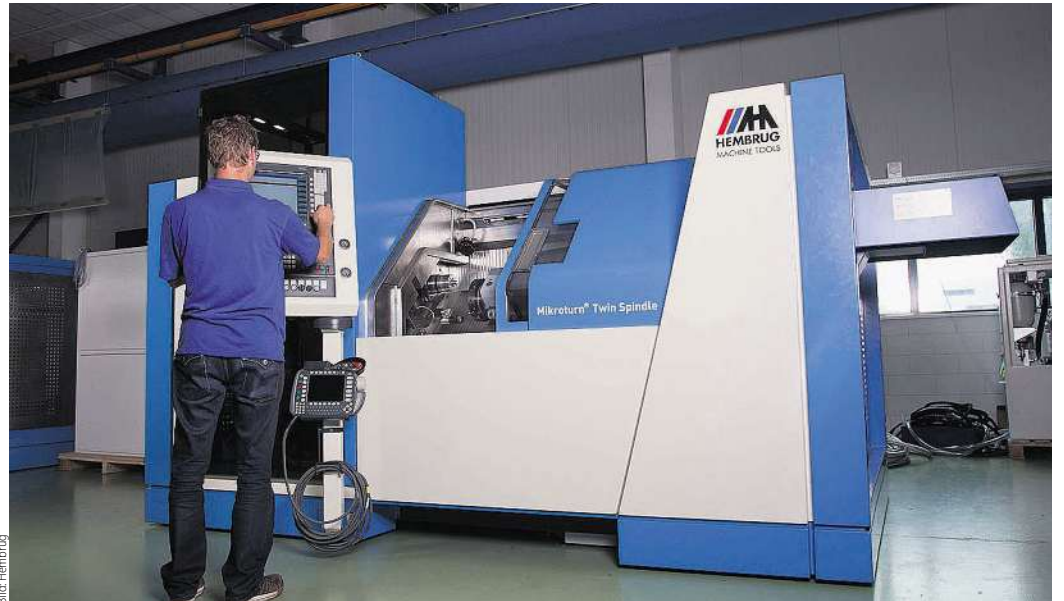
Die Mikrotorn Twin Spindle bietet eine Rundlaufgenauigkeit von 0,1 µm. Ihre Wiederholgenauigkeit liegt in der gleichen Größenordnung.
