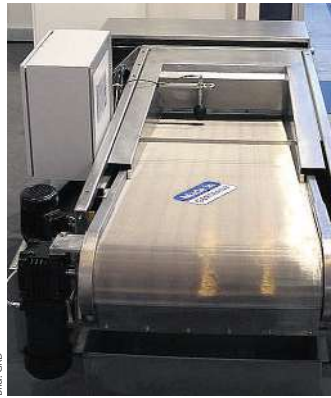
Mehr Kosteneffizienz versprechen Bandfilter mit Edelstahlgewebe. Sie werden als Alternative zu Papierbandfiltern präsentiert.
