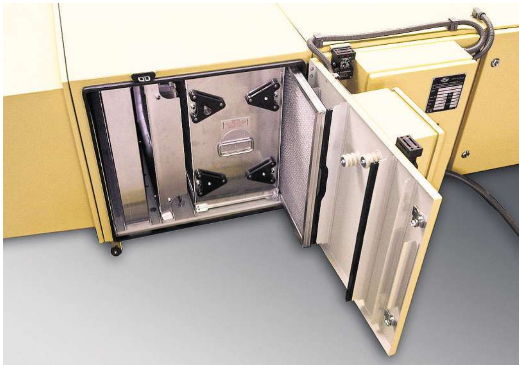
Filtersystem mit zwei elektrostatischen Filterstufen und Drahtgestrickmatte als Vorfilter. In dieser Ausführung beträgt die Filterfläche 52 m 2 .
