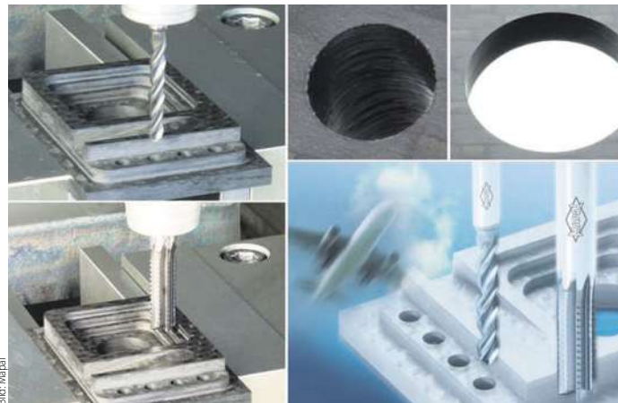
Delaminationsfrei aus dem Vollen herausgearbeitet mit dem Fräser Optimill-Composite-Speed und den Bohren Mega-Drill-Composite-MD und -UDX an einem CFK-Block.
