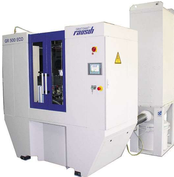
Bei der Gestaltung der Maschinenumhausung dieser Entgratmaschine standen Ergonomie und kompakte Bauform im Vordergrund.
