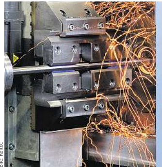
Mit den Reitec-Hartwirbelmaschinen vom Typ HWM können zum Beispiel Kugelrollspindeln mit 60 HRC ohne Schneidöl und in einem Durchgang gefertigt werden.
