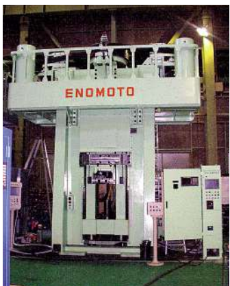
Die vertikale Stauchpresse von Enomoto ist mit einem Servoantrieb ausgerüstet und damit fähig, Stanzteile naht- und gratlos herzustellen.
