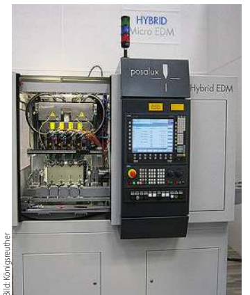
Die Microfor HP4 EDM ist eine Erodiermaschine zur präzisen Herstellung von Mikrobohrungen im Durchmesserbereich von 50 µm bis 1,8 mm. Auch konische Löcher können erzeugt werden. Die mögliche Konizität wird mit einem Wert von 150 µm/mm angegeben. Mikrorisse werden vermieden.
