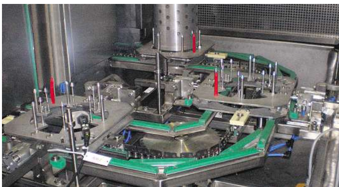
Nach der automatischen Beschickung werden die Bauteile auf einem kurvengeführtem Fördersystem getaktet durch die Durchlaufreinigungsanlage transportiert.
