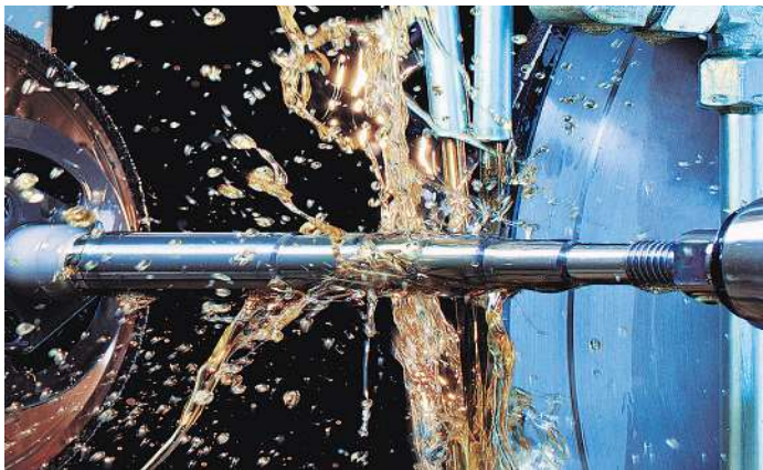
Ein HM-Stufenbohrer wird in Hochgeschwindigkeit auf einer Grindor Speed ge- schliffen.
