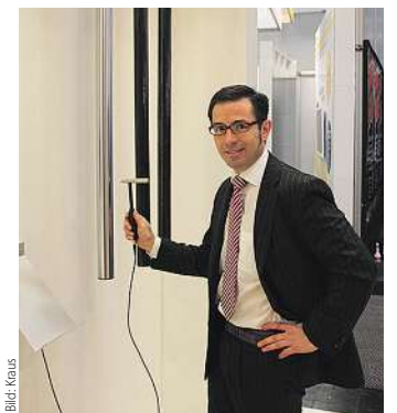
Xperion-Vertriebsleiter James Royal Schildknecht zeigt das gute Dämpfungsverhalten von CFK bei einem Schwingungsversuch mit senkrecht aufgehängten Rohren.
