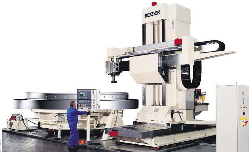
Für die Bearbeitung von Werkstücken mit einem Durchmesser von 200 bis 6000 mm und Gewichten bis 100.000 kg stehen Maschinentische in verschiedenen Größen und Ausführungen zur Verfügung.
