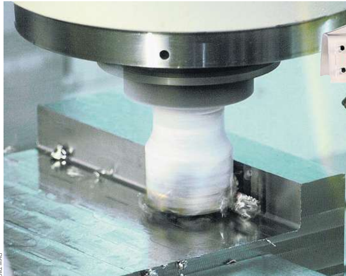
Die Zerspanung mit Stickstoff ermöglicht eine signifikante Steigerung der Schnittgeschwindigkeiten für höhere Zerspanungsproduktivität, längere Werkzeugstandzeiten oder eine Kombination dieser beiden Vorteile, so MAG.
