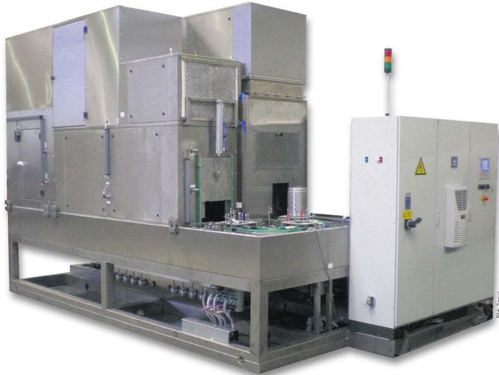
Die Durchlaufreinigungsanlage ZD-4500-RASTK arbeitet als einbahniges Spritzsystem. Sie umfasst die Prozesse Reinigen, Abblasen, Spülen, Trocknen und Kühlen.
