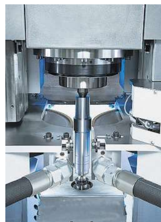
Beim Synchro-Stützscheifen verkürzt sich die Schleifzeit durch den Einsatz von zwei sich gegenüberstehenden Schleifscheiben.
