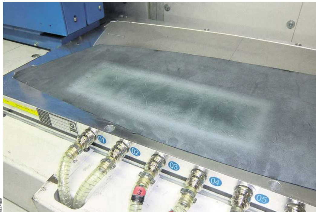
Nach erfolgter Bearbeitung sind die Sollbruchstellen des Lederzuschnitts ausgedünnt. Durch den schonenden Schleifprozess sind auf der Vorderseite keine Konturen sichtbar.
