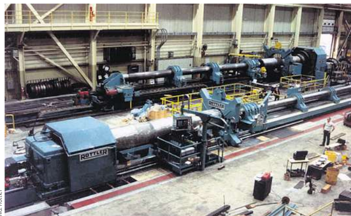
Tieflochbohrmaschinen der Baureihe ABD sind für die Dreh- und Ausbohrbearbeitung zur gleichzeitigen Innen- und Außenbearbeitung von zylindrischen Werkstücken entwickelt worden.
