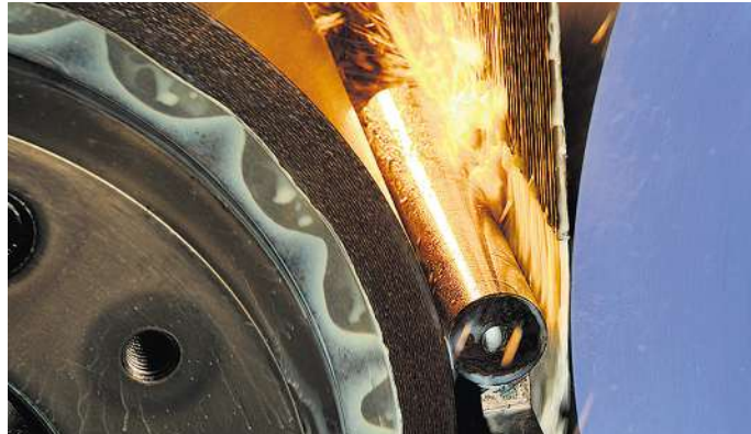
Die Bearbeitung einer Welle mit Geradeinstich im Prozess.
