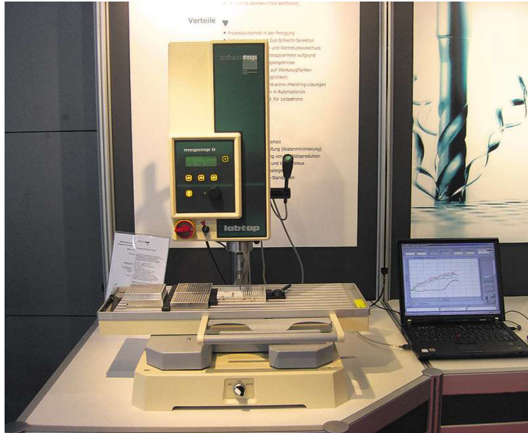
Mit der TTT-Methode lässt sich über den Verlauf des Drehmoments die Leistungsfähigkeit von Schneidöl und Werkzeug während des gesamten Gewindeschneidprozesses beurteilen.
