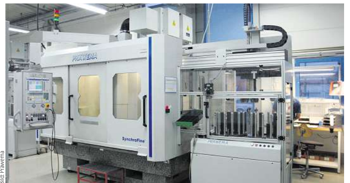
Bild: Präwema Die doppelspindlige Verzahnungshonmaschine Synchrofine 205 HS D ist für die produktive und flexible Bearbeitung von Zahnrädern vorgesehen.
