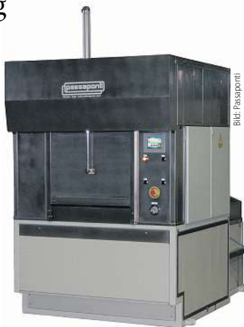
Die Anlage R-Evolve umfasst die Waschprozesse Spritz- und Tauchbadreinigung mit und ohne Ultraschallunterstützung.
