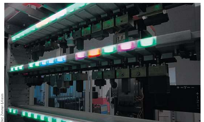
Diese Leuchtdioden zeigen den Status eines Werkstückes oder einer Elektrode mit bis zu sieben Farbwerten pro Diode an.
