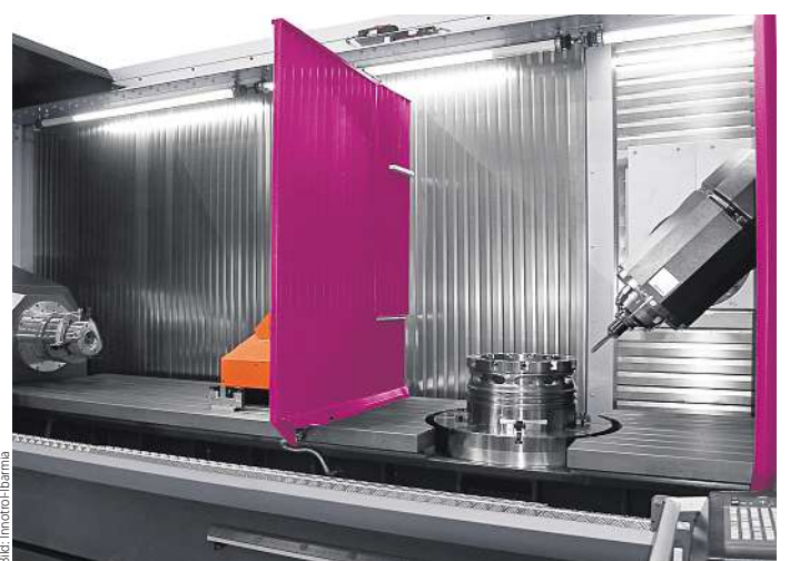
Blick ins Herz der optimierten Fahrständerfräsmaschine ZVH 45/L4000 Multiprocess mit integrierter Drehtechnik. Die Maschine erhöhe die Produktivität, ohne Flexibilität zu verlieren, sagt der Hersteller.
