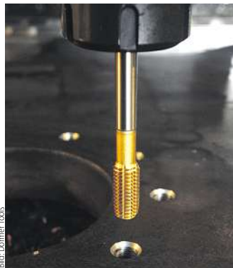
Die Spectrum-Gewindebohrer werden mit zwei verschiedenen Oberflächenbehandlungen angeboten.
