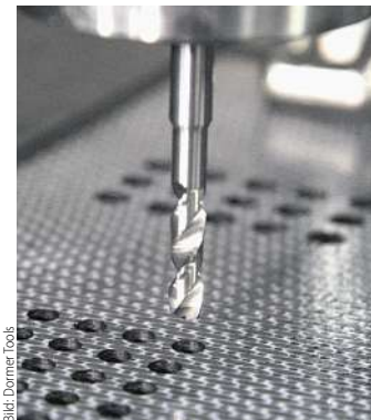
Der Hartmetallverbundbohrer R790 für Durchgangsbohrungen in Verbundwerkstoffen.
