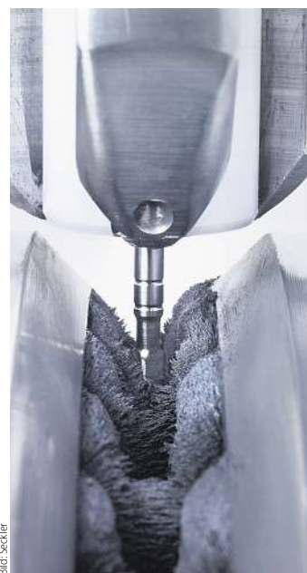
Der Raum zwischen Werkstück und Magnetkopf ist mit magnetischem, abrasivem Schleifpulver gefüllt, das mithilfe von Walzbürsten die Oberfläche entgratet.
