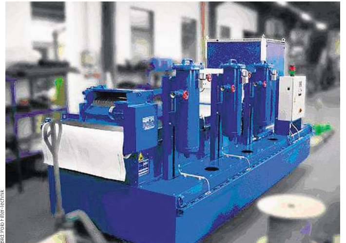
Die Filteranlage besteht aus mehreren Stufen. Vorgeschaltet ist ein stahlgewetzter Magnetfilter, ausgerüstet mit Dauermagnetringen von hoher Koerzitivkraft.
