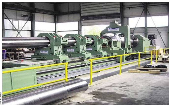
Die Maschinen der Baureihe TFB können in Abhängigkeit der erforderlichen Genauigkeiten mit drehendem Werkzeug, mit drehendem Werkstück oder mit drehendem Werkzeug und drehendem Werkstück ausgelegt werden.
