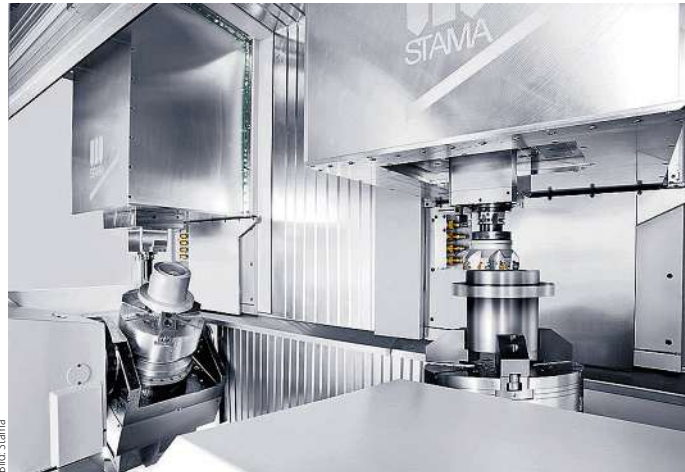
Bild: Stama Fräs-Dreh-Zentrum MC 734/MT-2C zur 6-Seiten-Komplettbearbeitung für große Werkstücke bis 450 mm Durchmesser.
