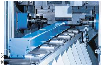
Die Langteile werden auf dem Maschinentisch zentrisch zur Bearbeitungsrichtung eingespannt. Die entsprechende Bearbeitungseinheit fährt dann das Werkstück an.
