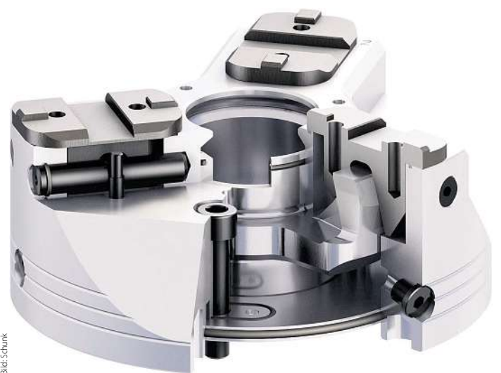
Schnittdarstellung des hermetisch dichten, dauergeschmierten Leichtbau-Drehfutters Rota NCL.
