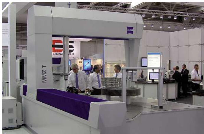
Das Koordinatenmessgerät MMZ eignet sich optimal für große Bauteile mit besonders engen Toleranzen.
