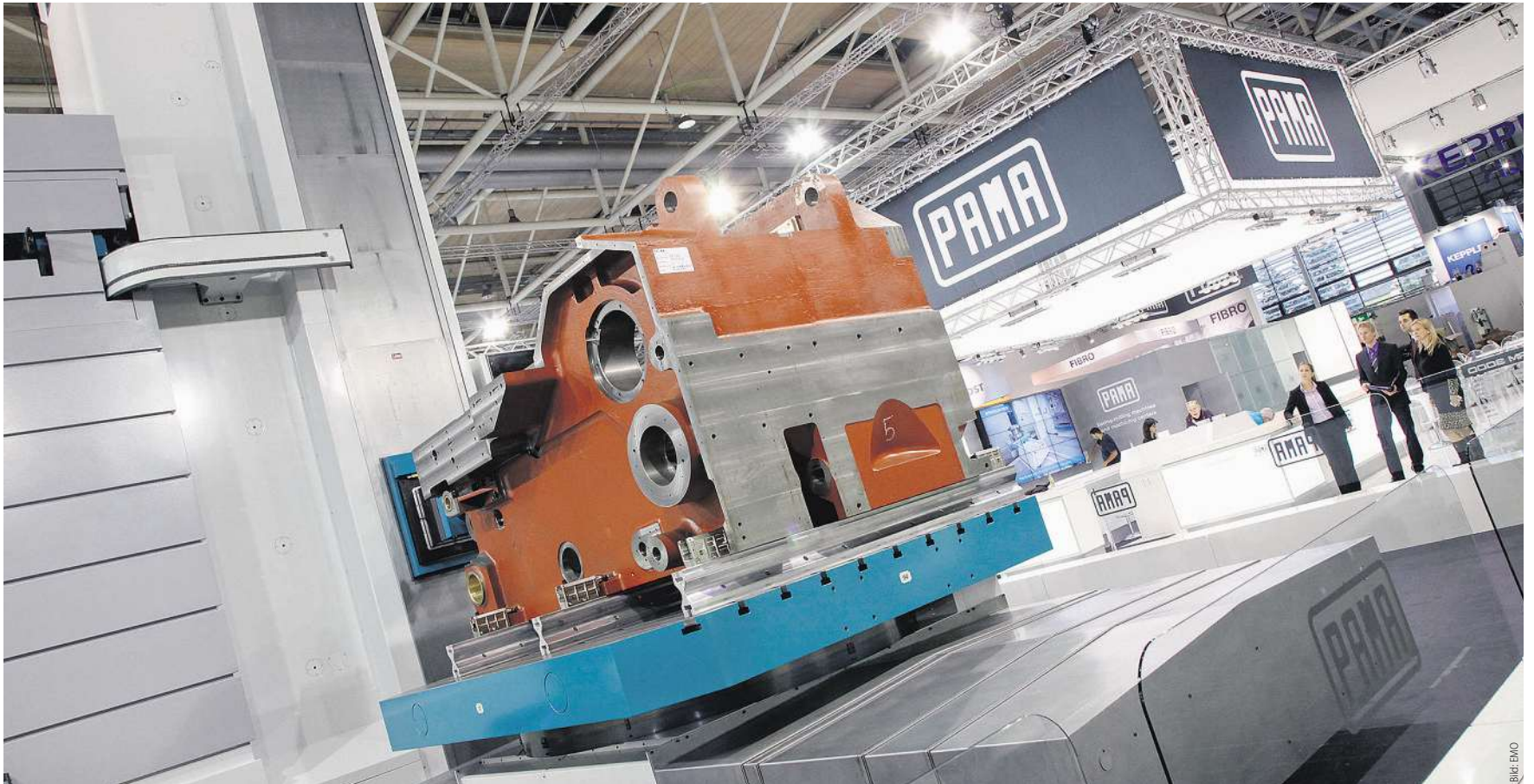
Erstmals präsentiert der italienische Großmaschinenbauer Pama die überarbeitete Version seiner Kernbaureihe Speedram. Nach dem Motto „Mehr Leistung zu einem besseren Preis“ bietet die Speedram 3000 unter anderem Verfahrensgeschwindigkeiten der Linearachsen von bis zu 25 m/min und die Spindeln können den Angaben zufolge hohe Drehzahlen, Leistungen und Drehmomente kombinieren.
