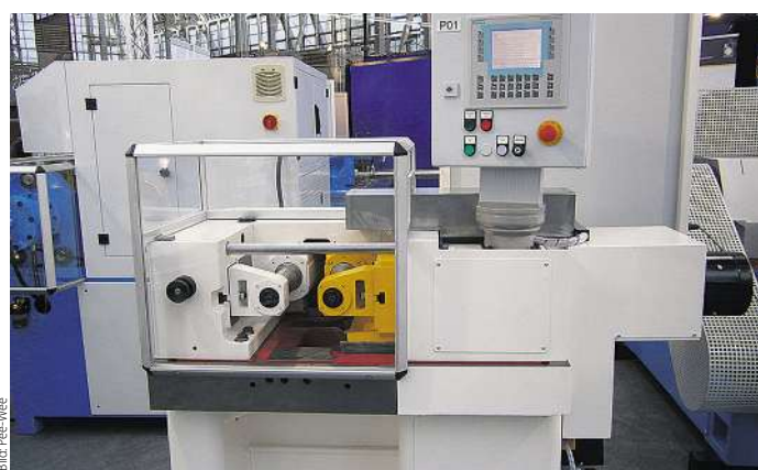
Die platzsparende Gewinderollmaschine P15 CNC wird über einen AC-Schlittenantrieb bewegt und verhindert so die übliche Versprödung von Titan und hochfestem Aluminium bei der Kaltverformung. Im Idealfall spart der Anwender im Vergleich zu hydraulischen Systemen 35% Energiekosten ein.
