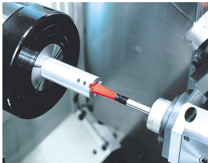
Zum Entgraten von Querbohrungen dienen die keramischen Schleiffasern.
