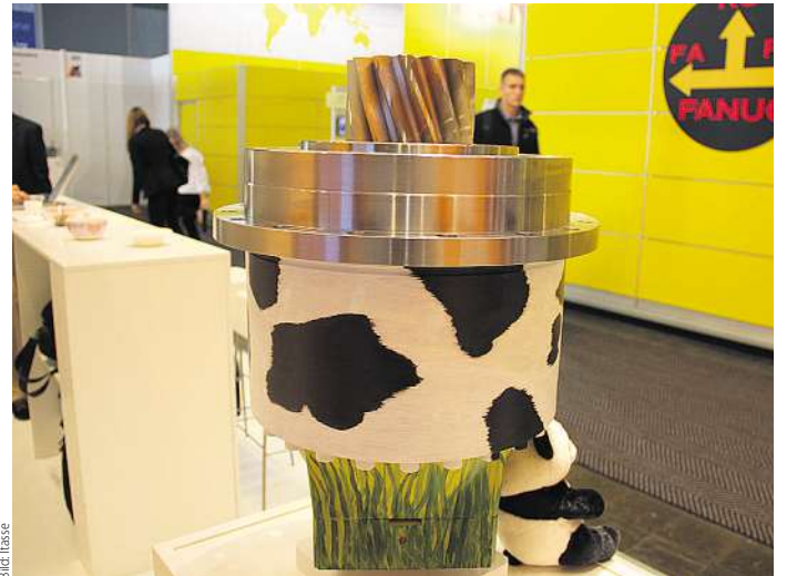
Das spielfreie Untersetzungsgetriebe KRP6 ist nicht nur das weltgrößte seiner Art, sondern arbeitet auch energieeffizient.
