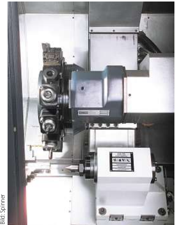
Die neue Kompaktdrehmaschine TC300 ist mit einem Spinner-Schaltrevolver der neuen Generation ausgerüstet.
