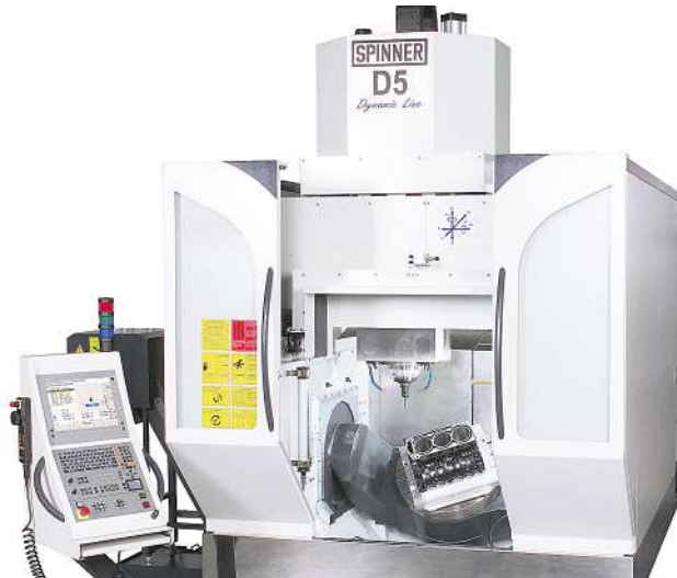
Wie alle Spinner-Maschinen haben die Bearbeitungszentren der neuen D-Baureihe einen soliden Aufbau mit Monoblock-Gussbett.
