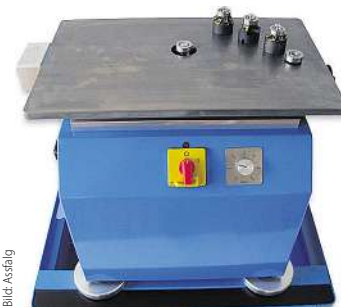
Die Kanten- und Konturfräsmaschine kann dank neuer Kugellagertechnik mit einem Fräser gerade Fasen wie auch Radien anbringen.
