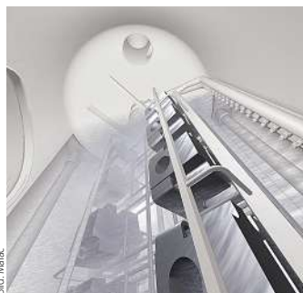
Die Korb-Düsen-Rotation ist die Basis für das Reinigen in Flussrichtung zur Erreichung reproduzierbarer Reinigungsergebnisse.
