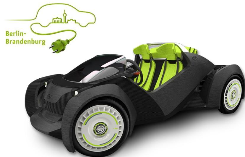
Erstes E-Fahrzeug aus dem 3D-Drucker: Der Strati von Local Motors
