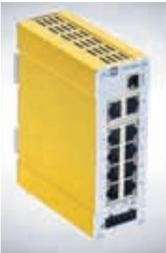
tenmanaged Switch, der über einen USB-Anschluss via FTS-Manager konfiguriert werden kann. Damit soll die einfache Handhabung eines Plug-and-play-Geräts mit den individuellen Einstellmöglichkeiten abgestimmt auf die jeweilige Automatisierungsanwendung verbunden sein. Anschlussbezogene Einstellungen wie Datenrate, Duplex-Modus und Port Mirroring können laut Hersteller einfach vorgenommen werden.
