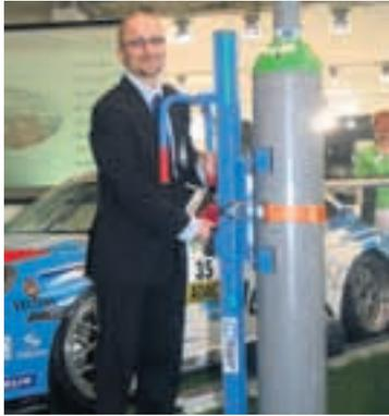
gehandelt werden. Mit einer Spannvorrichtung wird die Gasflasche aufgenommen und kann nun bequem gehoben, gesenkt und verfahren werden. **CO**
