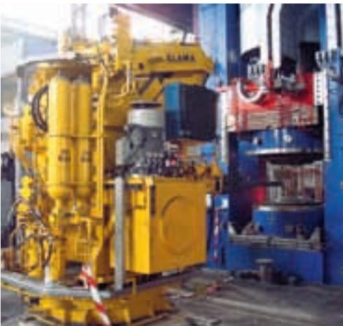
der: In einem Stößelhub vollzieht sie mehrere Arbeitsschritte. So finden das Kümpeln des ausgewalzten Rades, das Maßkalibrieren und das Lochen der Radnabe gleichzeitig statt. „Unter Kümpeln versteht man in diesem Fall das Umformen der inneren Radschüssel von einer symmetrischen zu einer asymmetrischen Kontur“, erläutert Osen. Dabei werde die Radnabe axial versetzt. Dieser Prozess und das notwendige
